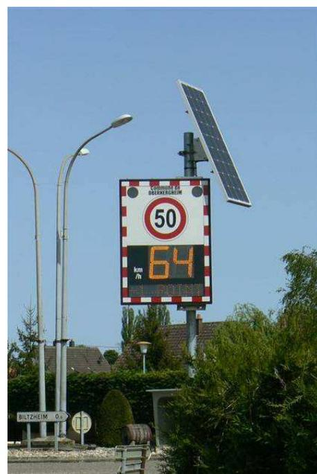
Les radars préventifs ont été installés rue Principale (entrées nord + sud et au niveau de la zone 30 dans les deux sens de circulation) ainsi que rue de Rouffach (entrée ouest). Une batterie est rechargée soit par l'éclairage public pour permettre le fonctionnement du radar dissuasif de vitesse en journée, soit par un capteur solaire afin que le radar informe les usagers de la route la nuit.
